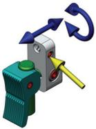
Mittels des obersten Gewindestiftes wird das „EXPERT“ Abzugszüngel auf der Abzugsstange der jeweiligen Matchwaffe befestigt. Das Zügel ist stufenlos in Längsrichtung der Waffe beweglich und kann gleichzeitig seitlich ausgeschwenkt werden. Durch Festziehen des Gewindestiftes kann das Abzugszüngel in seiner gewünschten Position arretiert werden.
