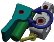
Auf der Unterseite der Grundplatte befindet sich ein weiterer Gewindestift. Durch diesen lässt sich die Neigung der Zügelplatte einstellen.
