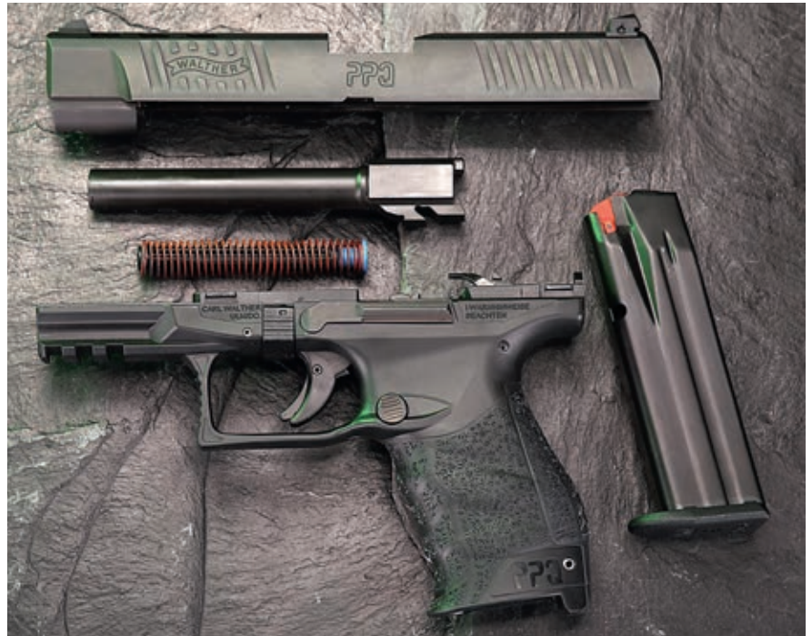
Das Zerlegen erfolgt ähnlich wie bei einer Glock über das Betätigen des Abzugs und das Herunterziehen des Demontageriegels oberhalb des Abzugszüngels.
