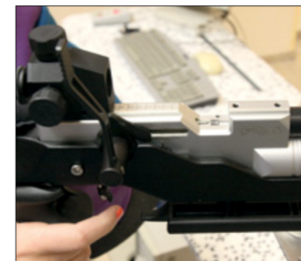
Das Black TEC verfügt über das aktuelle 400er-System mit großem Ladehebel und Lademulde.
