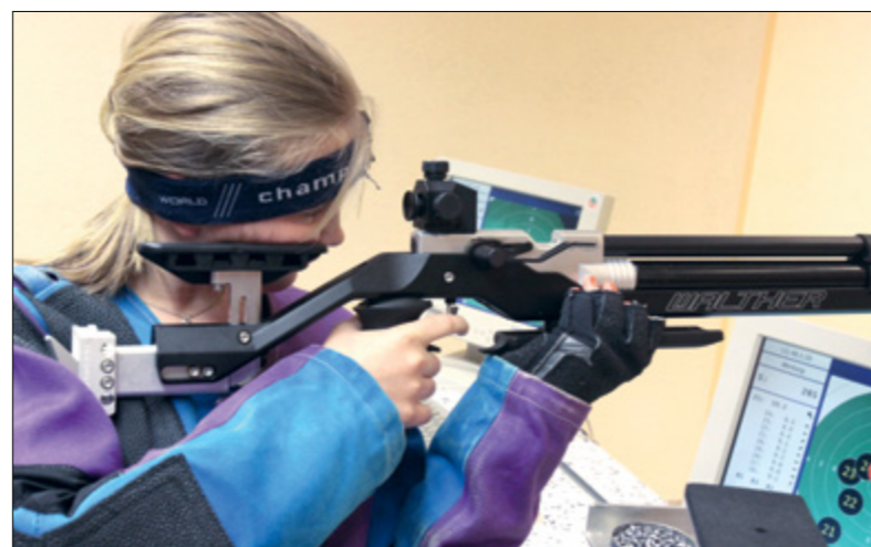
Kernstück der Schaftanpassung bildet beim Aluschaft die Einstellung per Alu-Ausleger (Speed-System), die im Gegensatz zu den Alu-Topmodellen ohne Skalierung kommen.
