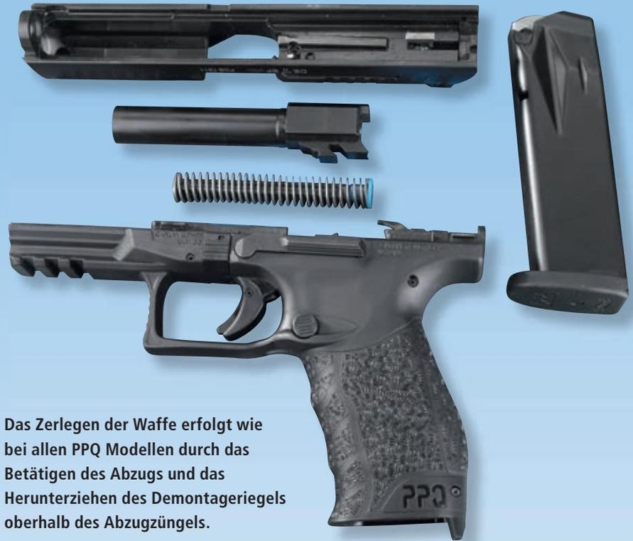
Das Zerlegen der Waffe erfolgt wie bei allen PPQ Modellen durch das Betätigen des Abzugs und das Herunterziehen des Demontageriegels oberhalb des Abzugzüngels.
